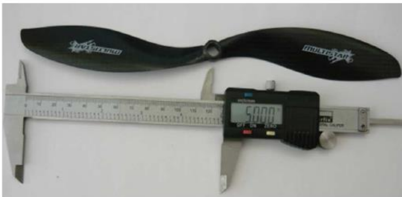
3. ábra: A kísérlethez használt CFRP propeller fotója, a tolómérő kijelzője inchben mutatja a méreteket (saját szerkesztés)
